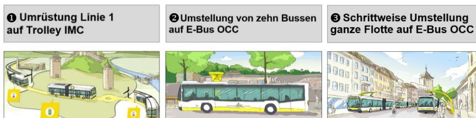
Während die bestehenden Dieselsebusse schrittweise auf E-Busse mit Schnellladesystem (OCC-Technologie, Phasen 2 und 3) umgerüstet werden sollen, ist für die sieben bestehenden Trolleybusse eine Umrüstung auf die IMC-Technologie vorgesehen (Phase 1).
