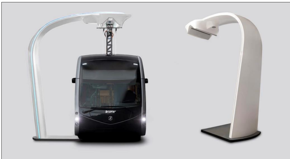
Abbildung 2: Bus bei der Schnellladung mit dem Pantograph am Ladearm
