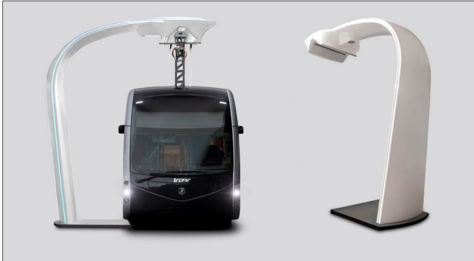
Abbildung 20: ieTram bei der Schnellladung mit dem Pantograph am Ladearm (Standard-Design des Herstellers)
