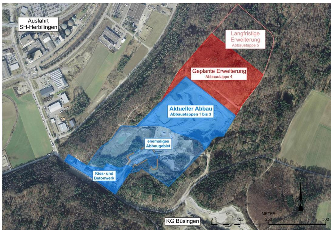
Abbildung 1: Kiesabbau Gebiet Solenberg mit geplanter Erweiterungsetappe 4 (vorliegende Planung) und der langfristig angedachten Erweiterungsetappe 5 (informativ) (Plan: ilu AG)
